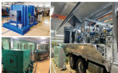
小型中性子源システムRANS (左上: RANS-I 左下: RANS-II 右: RANS-III)
