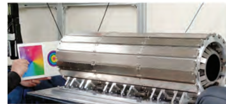
金属基材を用いた全周型中性子集光回転槽円ミラー
