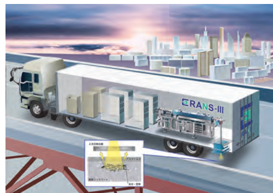
床版内部劣化非破壊検出システム (未来予想図) 小型中性子源反射型イメージングによるアスファルト層の下の劣化を見つける
