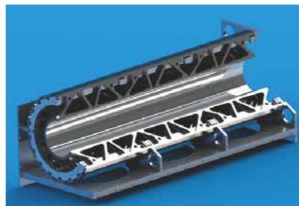
超精密加工技術により開発中の金属基材を用いた中性子ビーム集光用回転楕円ミラー
