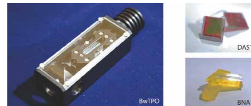
理化学研究所で開発されたテラヘルツ波光源 (左) と有機非線形光学結晶 (右)
