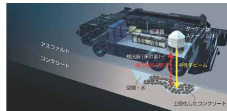
床版内部劣化非破壊検出システム(未来予想図) 小型中性子源反射型イメージングによるアスファルト層の下の劣化を見つける
