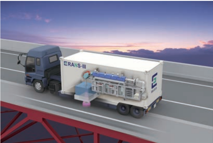
床版内部劣化非破壊検出システム（未来予想図） 小型中性子源反射型イメージングによるアスファルト層の下の劣化を見つける
