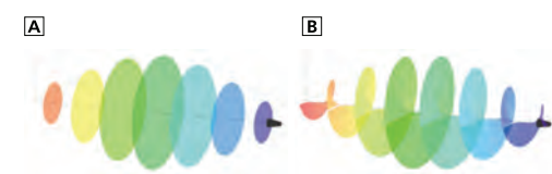
図1 通常のレーザー光の位相Aと光渦のレーザー光の位相B
