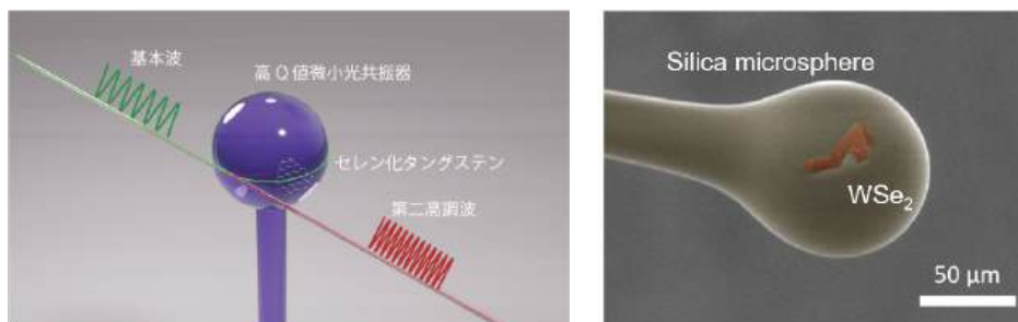
図1 (左) 高Q値微小光共振器とセレン化タングステンを組み合わせたハイブリッドデバイス (右) 走査電子顕微鏡像。
