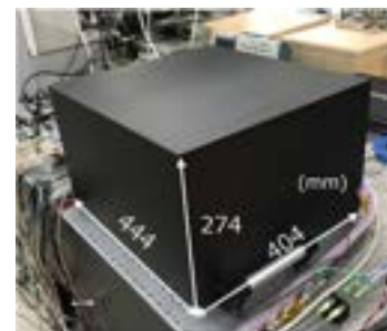
図2 次世代小型光格子時計の物理パッケージ。物理パッケージとレーザー光源システムを含めて総体積250 L（従来の7分の1）のシステムを開発しました。
