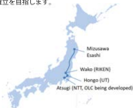
図1 和光市（理研）と水沢江刺（国立天文台）を繋ぐ長距離光ファイバリンク。可搬型光格子時計を水沢江刺に輸送し、理研との間を繋ぐ光ファイバを用いて、理研の時計と水沢江刺の時計の周波数を遠隔比較する。
