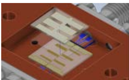
図2 希釈冷凍機内のチップマウントの様子 Fig.2 Schematic of chip mounting in a dilution refrigerator
