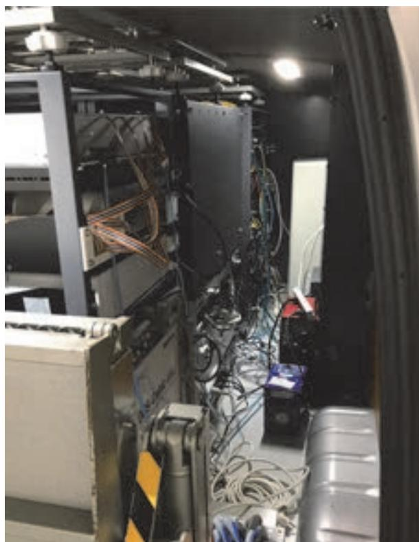
図1 車載型光格子時計。外部の時計と光ファイバーで繋いで時計周波数を比較することで、2台の時計の標高差が一般相対性理論に基づいて測定できます。
