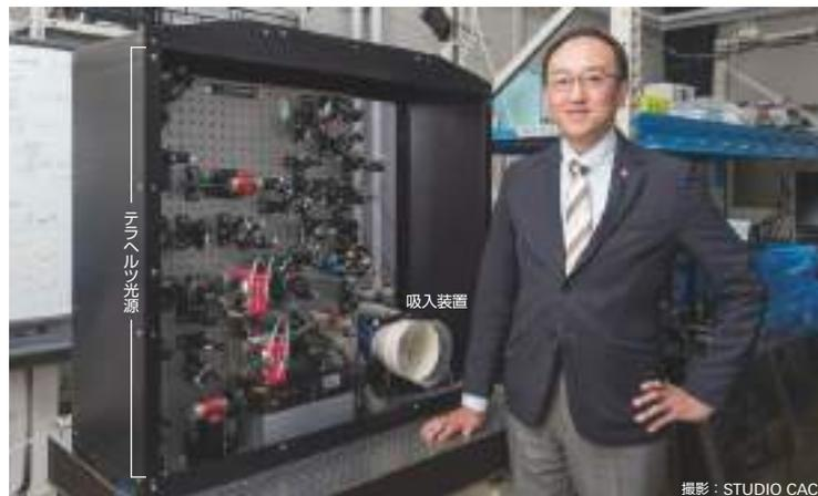
図4 危険ガス検出システムの試作品
