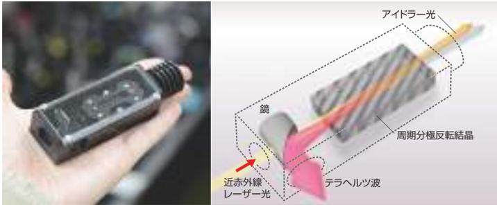
図5 周期分極反転結晶を用いたテラヘルツ光源
