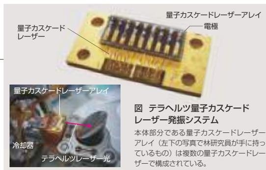
図 テラヘルツ量子カスケードレーザー発振システム
