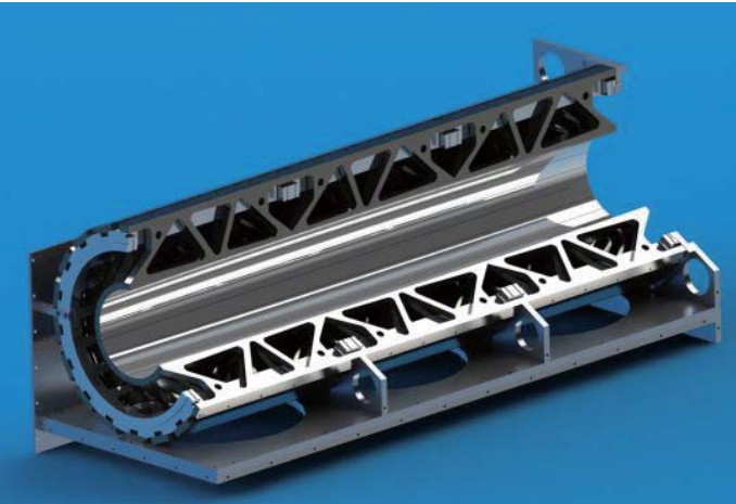
図 1：全周型 900mm 中性子集光用回転楕円ミラー Fig.1：An entire circumference 900mm ellipsoidal neutron focusing supermirror
