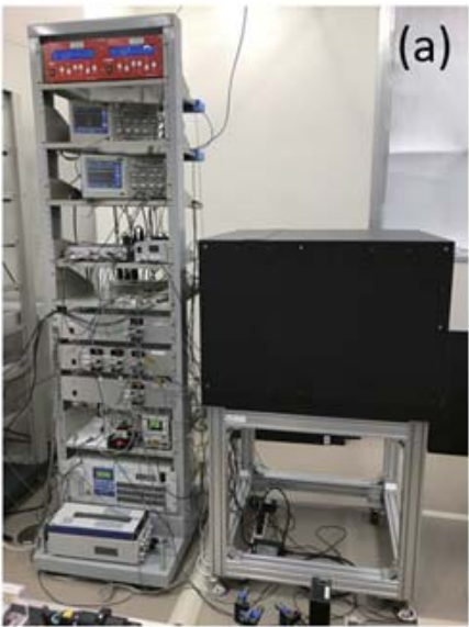
図 1 : (a) 可搬型光格子時計用真空システム。原子を分光する真空チャンバーは、黒い磁気シールドの箱の中に設置されている。(b) 光格子時計による時計遷移分光用レーザーの周波数補正の様子。25 日を超える長期無人運転を実現。
