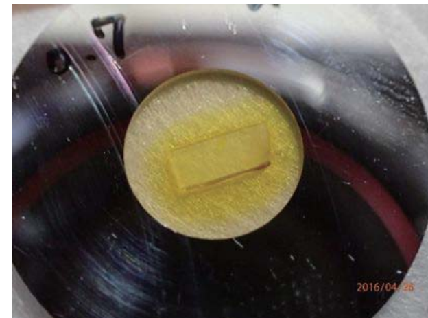
図 1：超精密切削加工による BNA 結晶 (010) 面 Fig.1: Precisely processed BNA (010) plane
